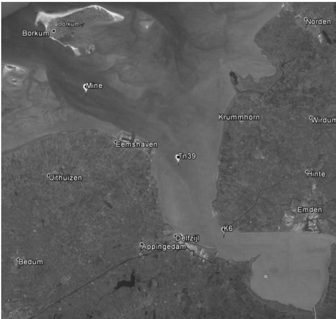
Abb. 11: Fahrwassertonnen Ems (09). Mine = Tonne Gefahrenstelle Mine (gelb-schwarz), Tn39 = Fahrwassertonne 39 (grün, Steuerbord), K6 = Fahrwassertonne 6 (rot, Backbord). © google earth.
