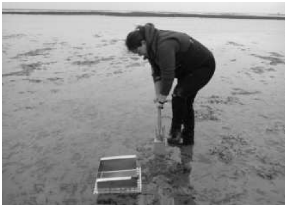
Abbildung 7: Weichbodenprobenahme mittels Handstechkasten auf der Austernbank Nordland.
